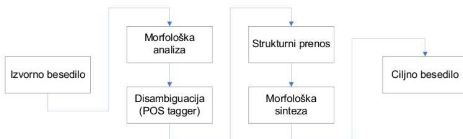
Slika 3.1: Moduli tipičnega sistema za strojno prevajanje na osnovi pravil plitkega prenosa. Ta arhitektura je bila najprej predstavljena v (Hajič et al., 2000) in pozneje uporabljena tudi v (Corbi-Bellot et al., 2005)
